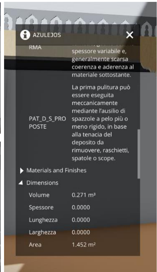
Informazioni parametriche della famiglia derivante dalla nurbs importata come patologia “deposito superficiale” (tesi di laurea di Giacomo Sorino, metodologia BIM e rilievo a servizio di architetture tradizionali, 2018)
