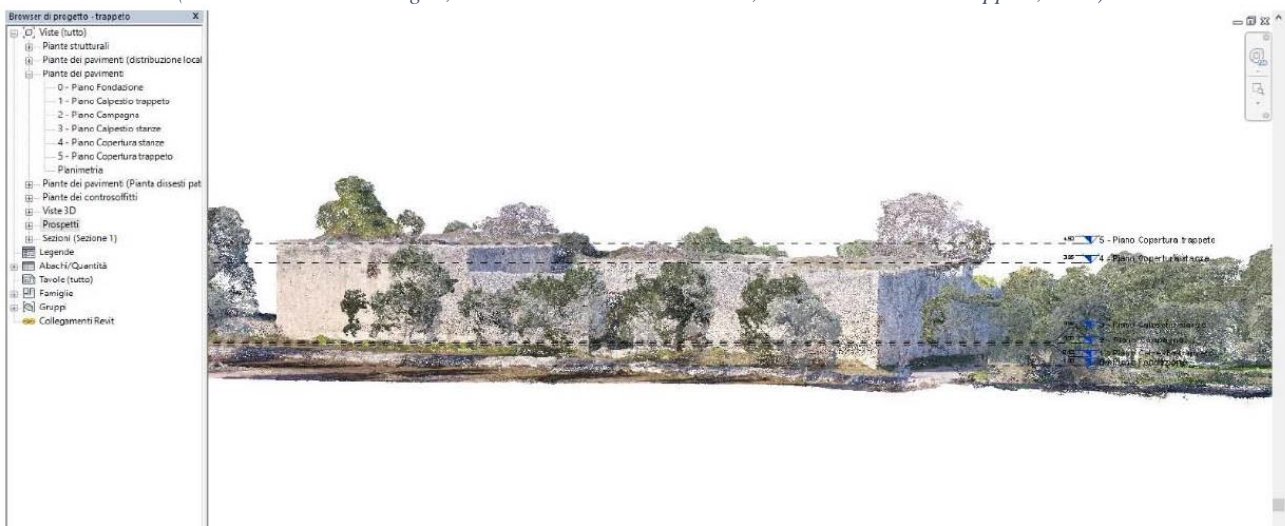
Importazione nuvola di punti, acquisita con tecnica fotogrammetrica aerea e terrestre, in software di modellazione BIM – (tesi di Domenico Modugno, Il rilievo del costruito nel BIM, Masseria Macchia Trappeto, 2016)
