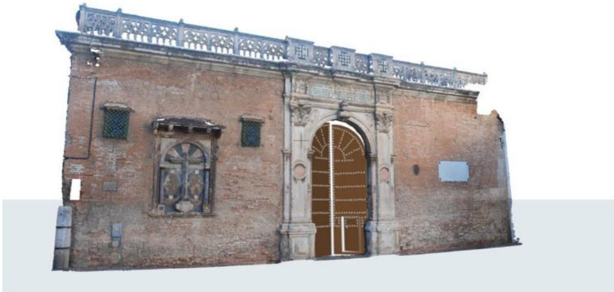
Modello geometrico della porta di ingresso principale della Casa di Pilato, Siviglia e inserimento nella nuvola di punti importata in ambiente BIM (J. Moyano, J. León, J.E. Nieto-Julián, S. Bruno, Semantic interpretation of architectural and archaeological geometries: Point cloud segmentation for HBIM parameterisation, Automation in Construction. 130 (2021))
