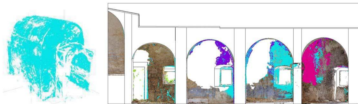
G. Importazione delle nuvole di punti relative alle forme di degrado, all'interno dell'ambiente BIM, previa segmentazione manuale o automatica delle stesse (tesi di laurea Tecnologie innovative di gestione della fase di diagnosi del costruito A. Gravina e V. Giannuzzi)
